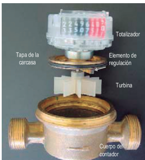
Despiece de un contador de chorro único.
